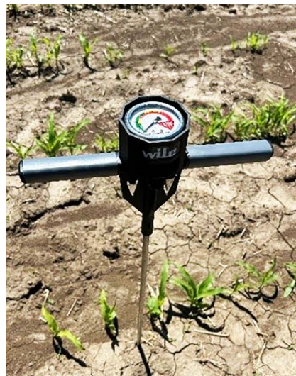
Рисунок 1 – Измерение твердости почвы ручным пенетрометром Wile Soil
