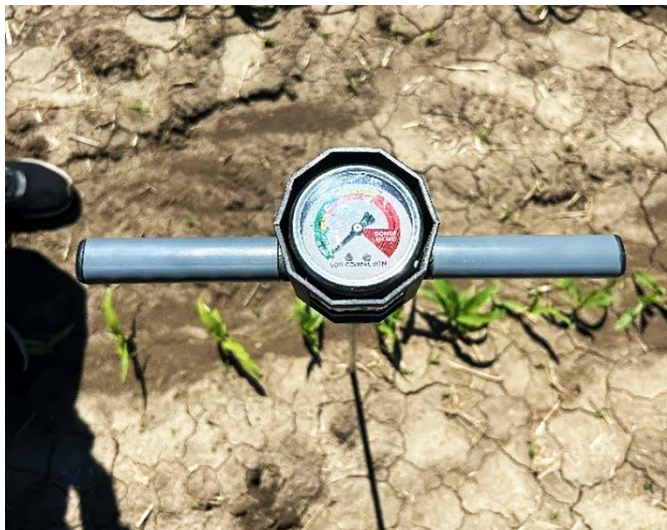
Рисунок 1 – Измерение твердости почвы ручным пенетрометром Wile Soil
