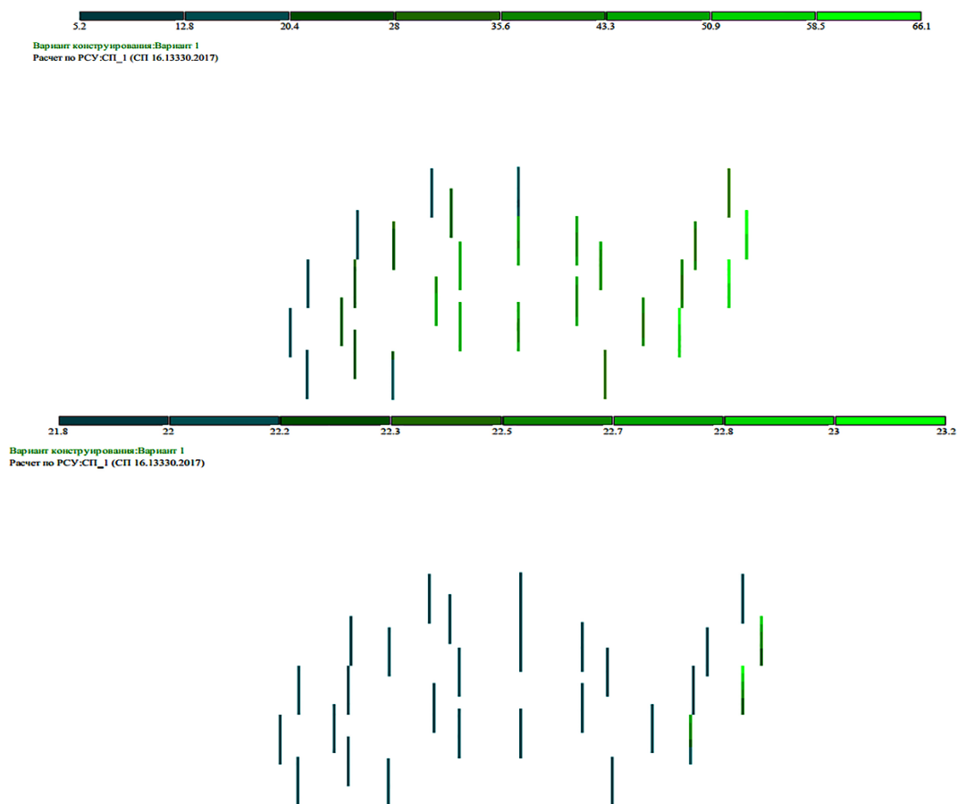
Рисунок 4 – Результаты проверки колонны первого этажа по первому и второму предельному состоянию
