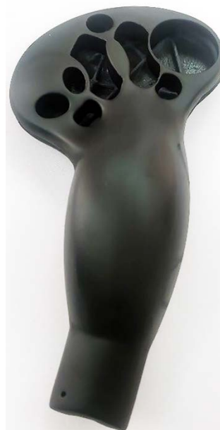
корпус ручки, изготовленный по технологии FDM-печати
