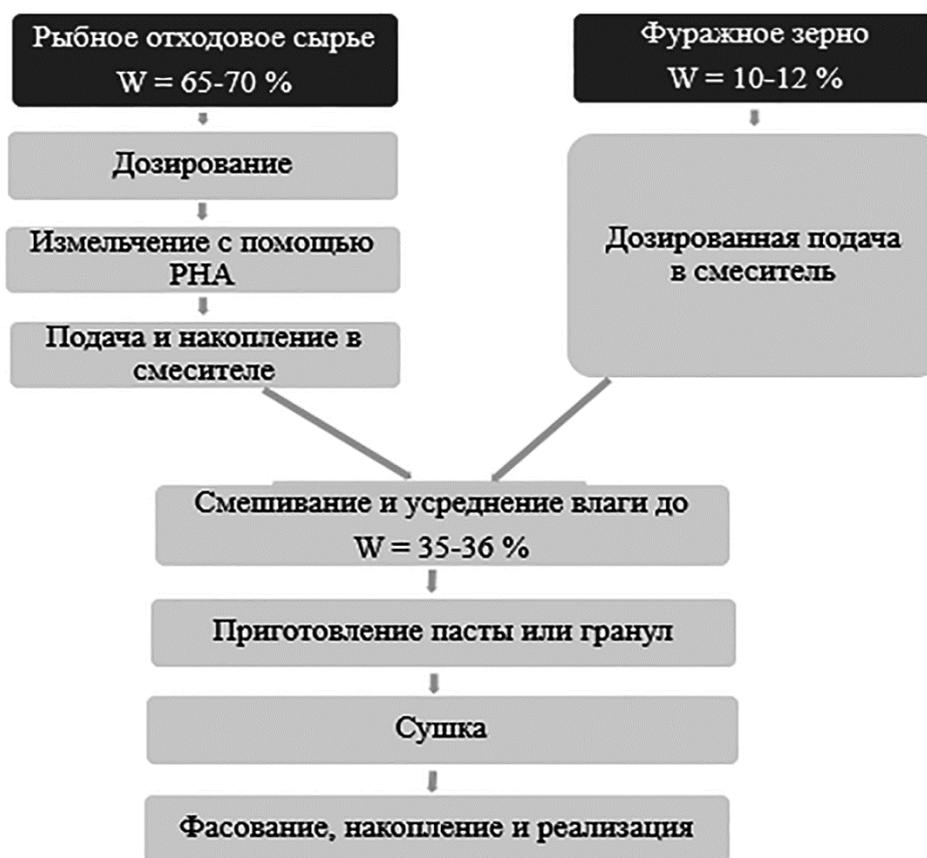
**Рисунок 1 – Принципиальная технологическая схема производства высокобелкового-кормового продукта для индеек**
