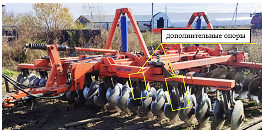
Рисунок 1 – Модернизированная дисковая борона БДТ-6ПР
