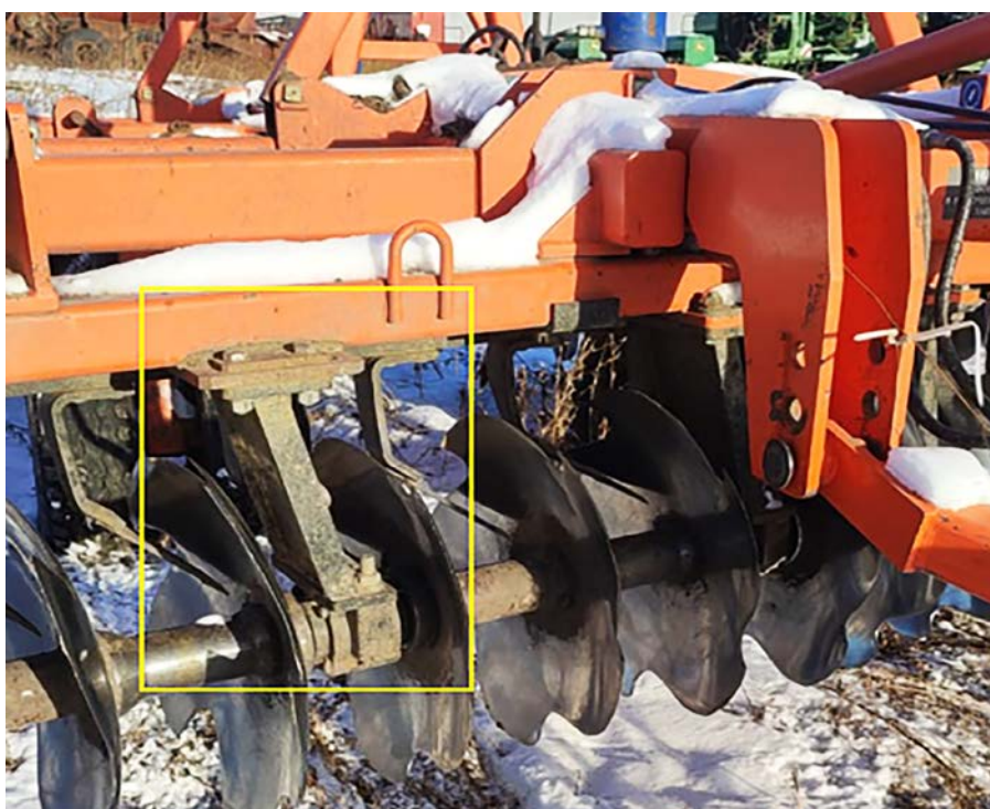
Рисунок 2 – Дополнительная опора дисковой батареи
