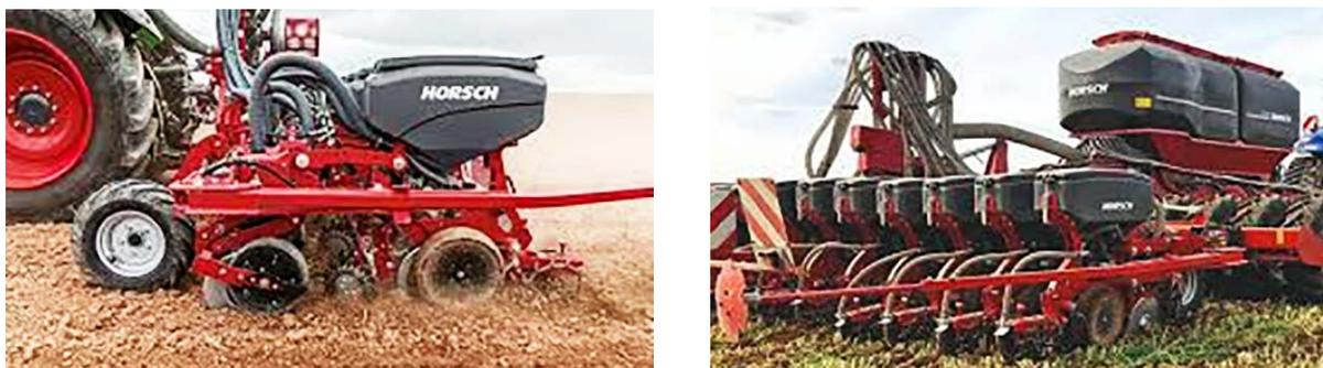
**Рисунок 2 – Пневматическая сеялка Horsch Maestro**
