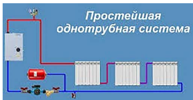
Рисунок 1 – Схема простейшей однотрубной системы
