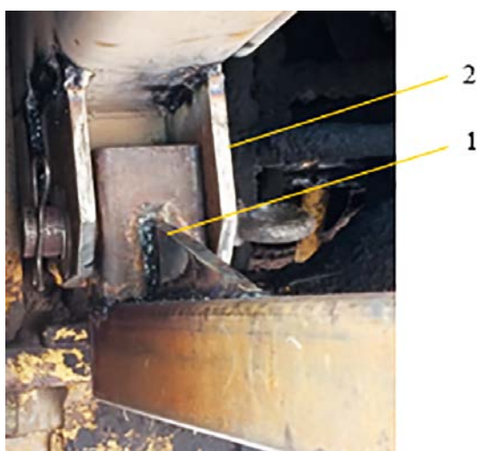
1 – проушины; 2 – косыночные упоры Рисунок 5 – Точки крепления пространственной рамы прокалывателя на колесном тракторе
