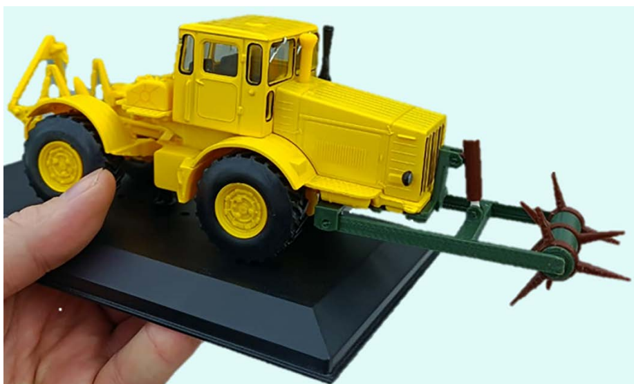
Рисунок 2 – Изготовление модели полурамного колесного трактора К-700 с установленным фронтально прокальвателем-щелерезом
