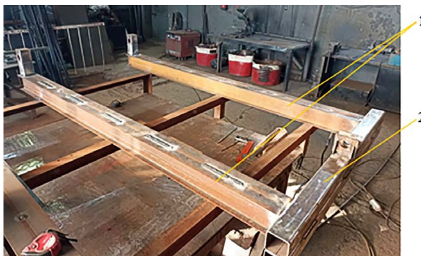
1 – две продольные трубчатые тяги; 2 – поддерживающая поперечная тяга Рисунок 3 – Основная рама фронтального прокальвателя-щелереза
