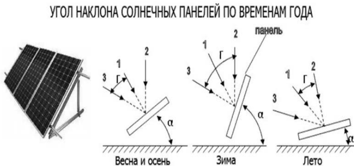
Рисунок 2 – Определение угла наклона солнечного коллектора
