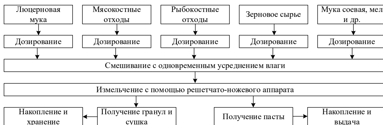
Рисунок 1 – Принципиальная технологическая схема получения кормовой добавки птице
