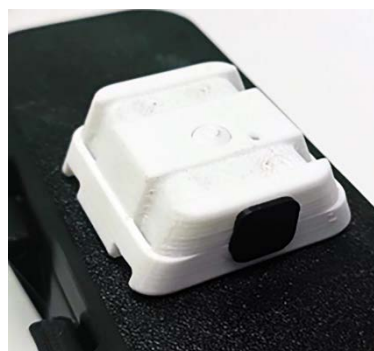
Рисунок 2 – Датчик инклинометр-акселерометр (слева), датчик инклинометр-акселерометр в разработанном прототипе корпуса с креплениями (справа)
