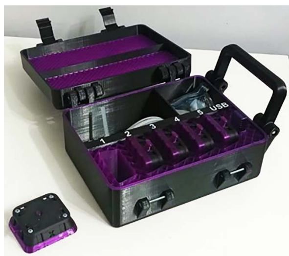
Рисунок 3 – Прототип (слева) и модернизированный (справа) корпуса датчиков и кейс приборного комплекса
