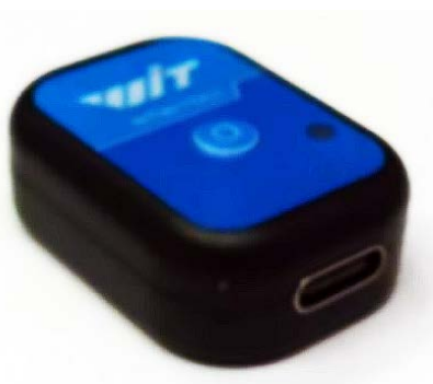
Рисунок 2 – Датчик инклинометр-акселерометр (слева), датчик инклинометр-акселерометр в разработанном прототипе корпуса с креплениями (справа)
