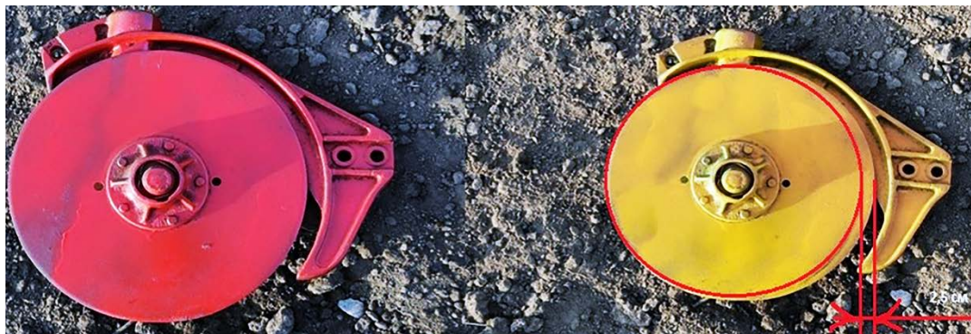
Рисунок 1 – Стандартный (слева) и модернизированный (справа) сошник сеялки
