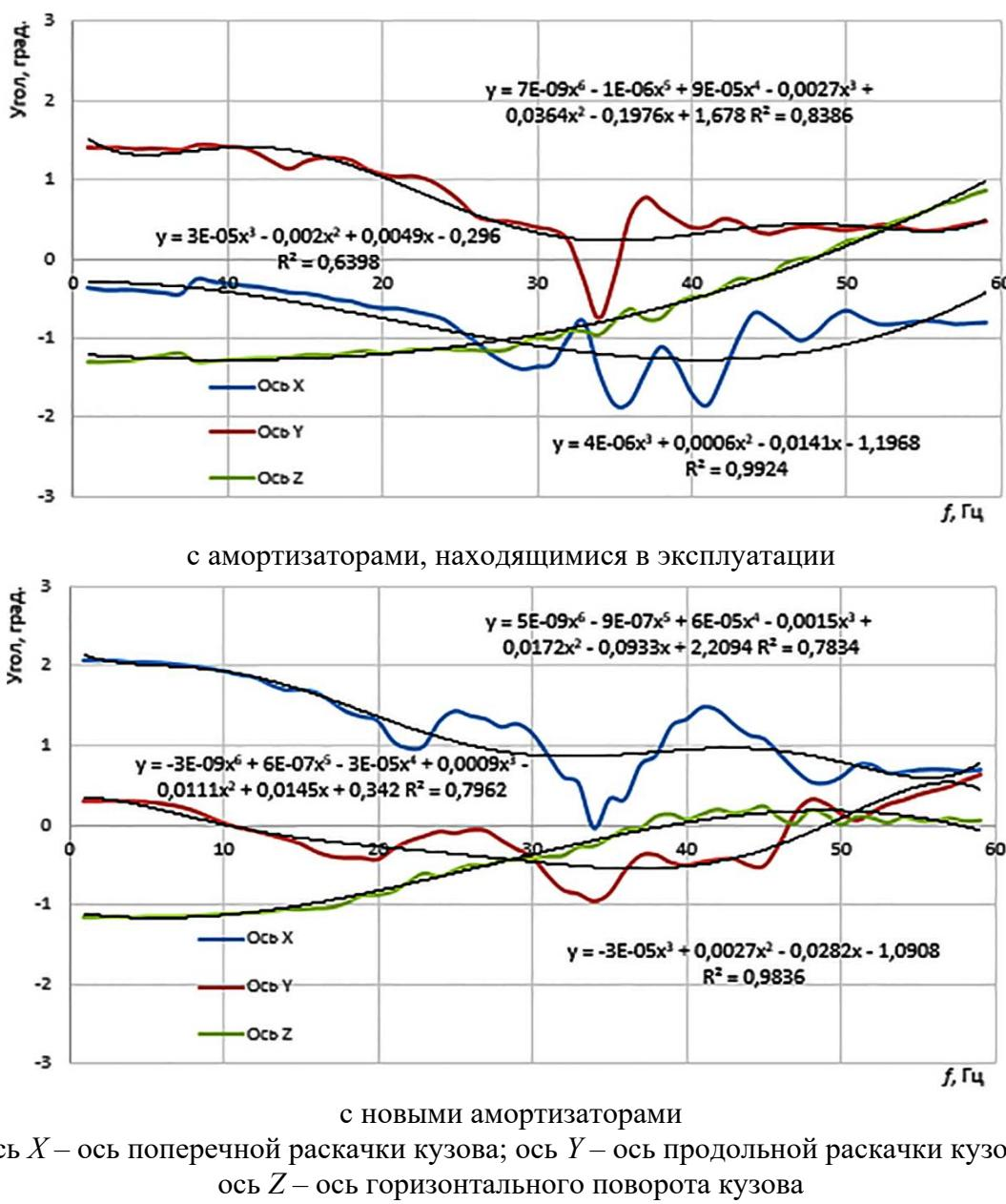
**Рисунок 1 – Амплитуды колебаний кузова автомобиля в снаряженном состоянии при преодолении двумя колесами передней оси неровностей высотой 50 мм со скоростью движения 5–7 км/час**
