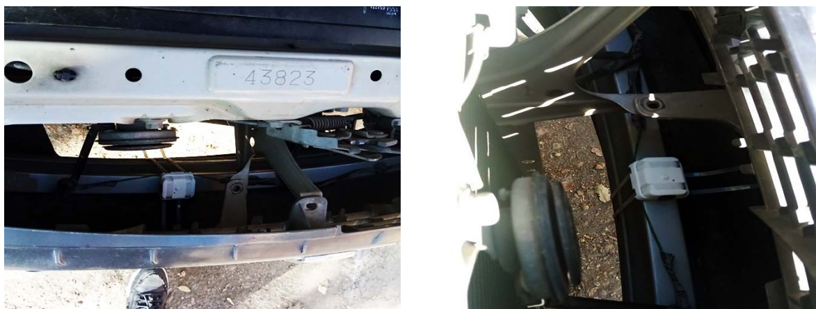
Рисунок 2 – Место крепления цифрового модуля «BWT901CL» на кузове автомобиля Toyota Premio
