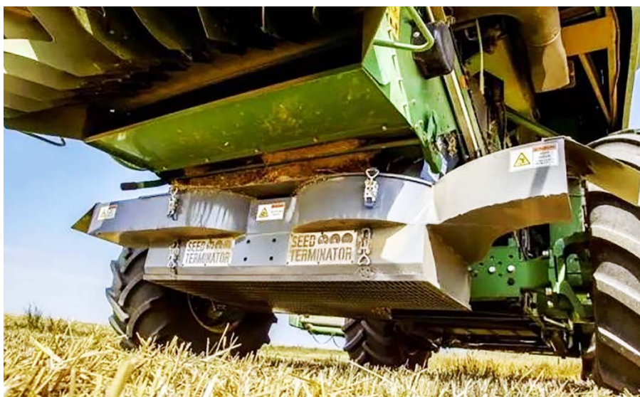
Рисунок 2 – Специальный модуль для агрегатирования с комбайном Seed Terminator
