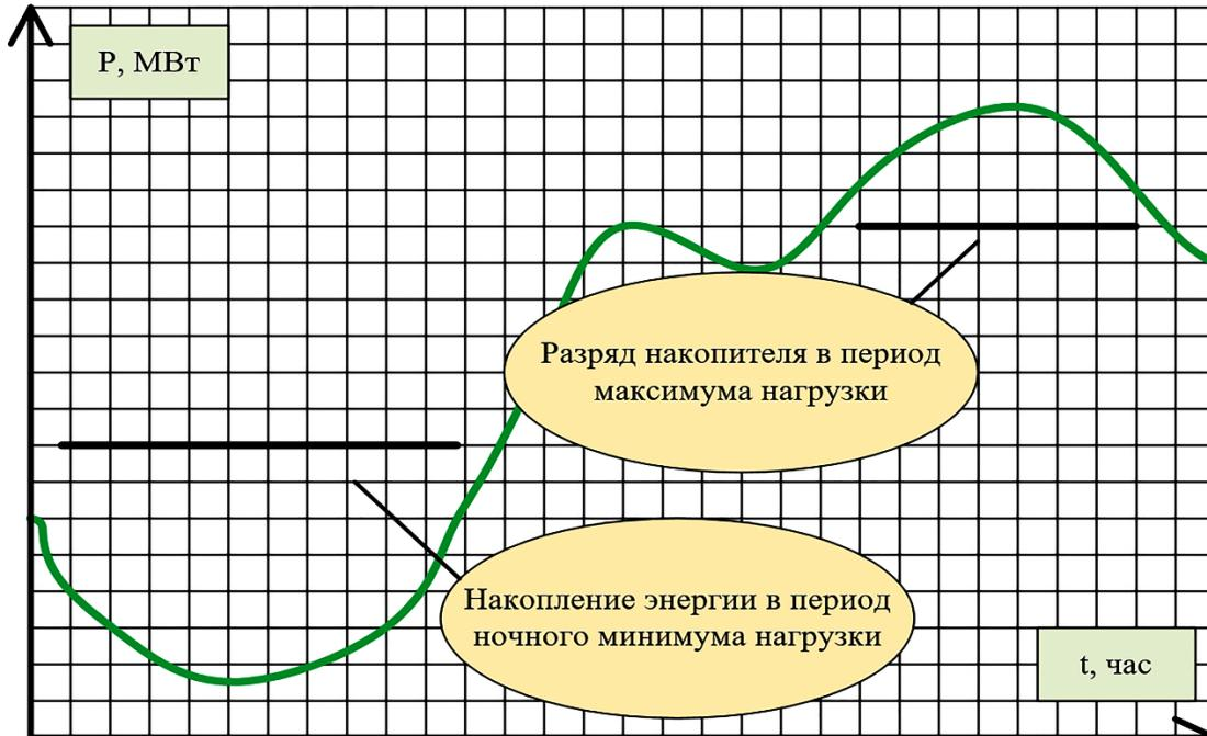
**Рисунок 1 – Выравнивание суточных графиков нагрузки**
