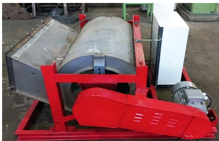
Рисунок 1 – Установка для проведения поисковых опытов по оценке количественных и качественных характеристик вентилятора очистки
